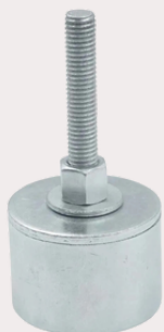
Saca e coloca rolamento base Lavadora
